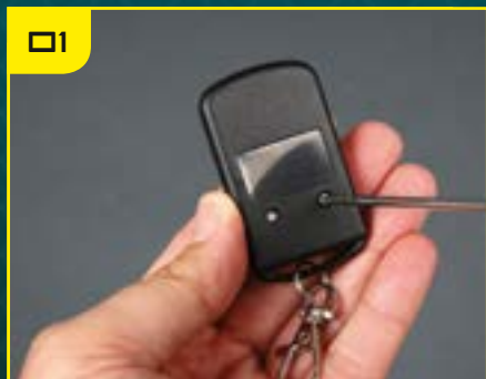
01 Выкрутите два небольших винта на обратной стороне пульта управления.
