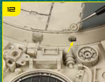
12 Зафиксируйте деталь 10 в небольшом углублении в кормовой части турели.
